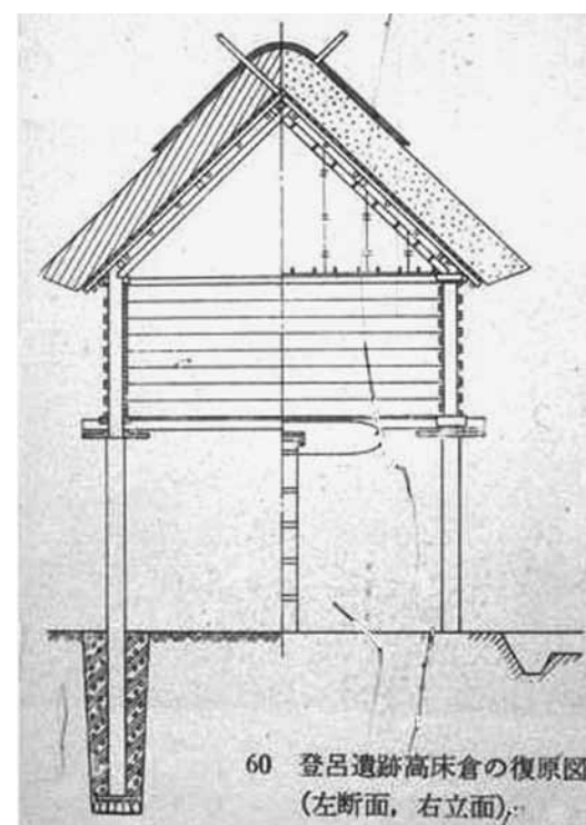
登呂遺跡の高床式倉庫の復元図 Section d'un grenier de style takayuka restitué à Toro
